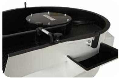
Part Load Inlet Malzeme Yükleme Girişi
