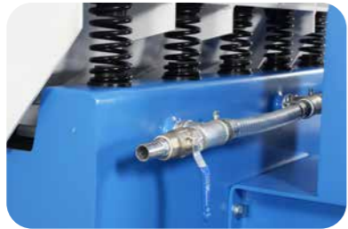
Dirty Water Discharge Valve Pis Su Tahliye Vanası
