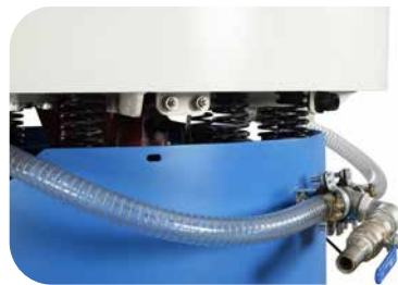
Dirty Water Discharge Valve Pis Su Tahliye Vanası
